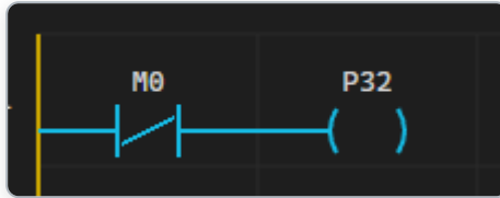
< 그림 5-6 NC 접점 예제 — M0 ON, P32 OFF(통전 끊김) >
