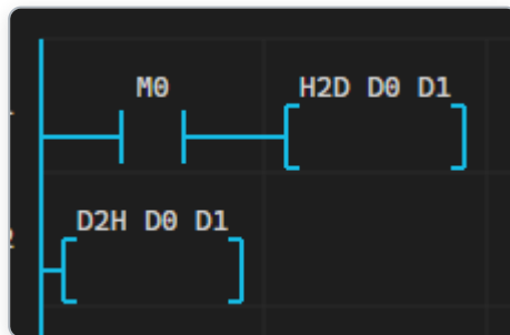
< 그림 6-25 BCD 변환 예제 회로 — M0 NO 접점 뒤 H2D D0 D1과 접점 없이 놓은 D2H D0 D1 >
