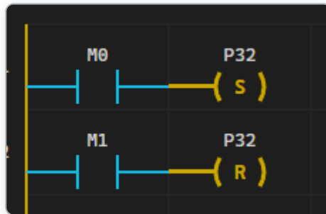
< 그림 5-10 SET 코일 예제 — M0 OFF로 복귀해도 P32는 ON 유지 >
