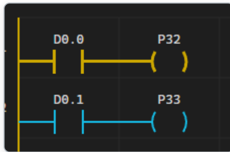
< 그림 5-21 워드 비트 점점 예제 — D0=1일 때 D0.0 점점(1단)만 통전, D0.1 점점(2단)은 비통전 >
