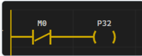
< 그림 5-5 NC 접점 예제 — M0 OFF, P32 ON(통전) >
